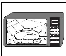
1. Микроволны, генерируемые магнетроном, равномерно распределяются в пище, благодаря тому, что она вращается на подносе. За счет этого пища готовится равномерно.
