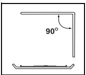
При чистке верхней части внутренней камеры печи вам будет удобнее чистить, если вы повернете нагревательный элемент вниз на 90° и затем почистите его.
